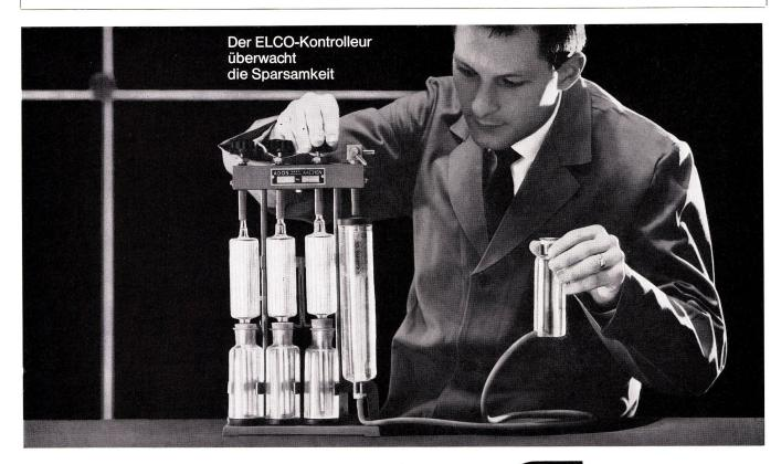
Bevor ein ELCO-Oelbrenner das Werk verlässt, wird er im Prüfstand einer exakten Schlusskontrolle unterzogen. Eine Phase daraus sehen Sie auf dem Bild! zehntelang. – Bauen Die Rauchgas-Analyse mit dem CO<sub>2</sub>-Prüfgerät. Damit wird der ELCO-Brenner auf sparsamste Verbrennung einreguliert. – ELCO-Oelfeuerungen Telefon 051 48 40 00
