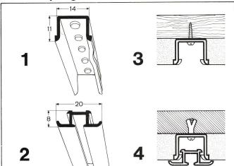
1. Tragprofil 3040 alle 2 cm gelocht. 2. Vorhangschiene 1027. 3. Tragprofil mit Schrauben, Dübel usw. auf Untergrund befestigt und eingeputzt. 4. Vorhangschiene 1027 in Tragprofil eingeklinkt. Die Tragnocken halten diese fest.
