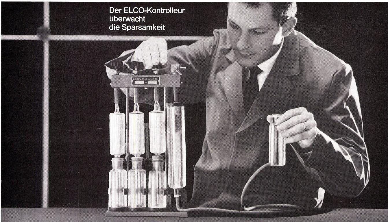
Bevor ein ELCO-Oelbrenner das Werk verlässt, wird er im Prüfstand einer exakten Schlusskontrolle unterzogen. Eine Phase daraus sehen Sie auf dem Bild! Die Rauchgas-Analyse mit dem CO<sub>2</sub>-Prüfgerät. Damit wird der ELCO-Brenner auf sparsamste Verbrennung einreguliert. — Die Schlusskontrolle gibt Ihnen und uns
