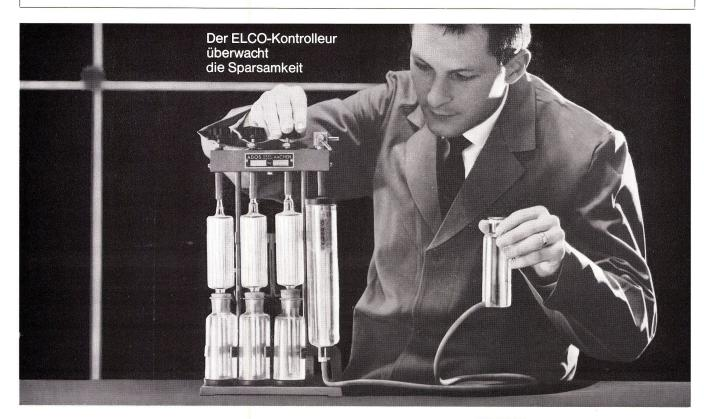
Phase daraus sehen Sie auf dem Bild! Die Rauchgas-Analyse mit dem CO2-Prüfgerät. Damit wird der ELCO-Brenner auf sparsamste Verbrennung einreguliert. — ELCO-Oelfeuerunger Die Schlusskontrolle gibt Ihnen und uns Telefon 051 48 40 00
