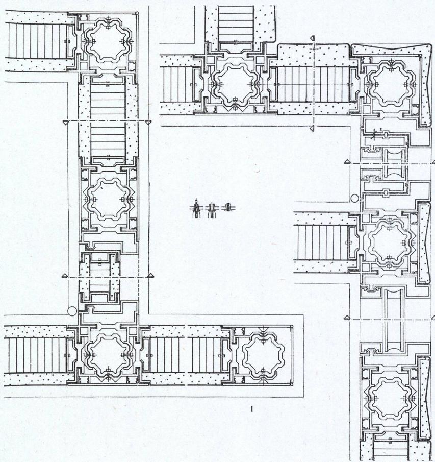
Le noyau porteur des éléments de cloison, plafond et plancher consiste en nid d'abeilles en aluminium collé entre deux tôles d'acier (paroi d'avion), système assurant une très grande rigidité. Le vide entre le nid d'abeilles et le cadre en tôle qui est galbé pour reprendre les dilatations, est rempli d'un isolant mousseux neutre.
