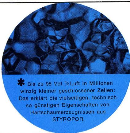
• trittschalldämmend • wärmeisolierend • alterungsbeständig
