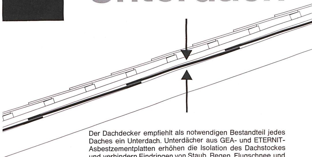
Der Dachdecker empfiehlt als notwendigen Bestandteil jedes Daches ein Unterdach. Unterdächer aus GEA- und ETERNIT-Asbestzementplatten erhöhen die Isolation des Dachstockes und verhindern Eindringen von Staub, Regen, Flugschnee und Rückschwallwasser.
