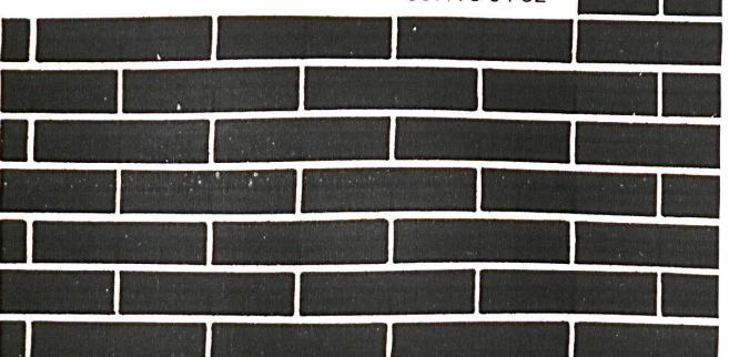
ist allerdings, daß der Schall innerhalb der Fugen mindestens 12 bis 15 cm Weg zwischen Ein- und Ausritt zurücklegt (Abb. 1).
