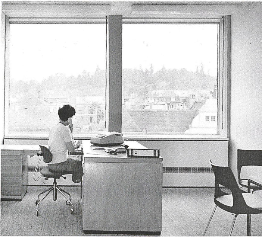
1 Normalbüro. Der Achs-Abstand beträgt 1,875 m. Bureau type. Distance entre les axes: 1,875 m. Standard office. Interval comes to 1.875 m.
