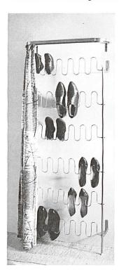
Die normale Schuhgarderobe für 18 Paar Schuhe hesteht aus Stahlrohrrahmen in der Höhe von 155 cm. Diese werden durch sechs Stahldrahtschlangen in der Breite von 65 cm miteinander verbunden und können mittels vier Winkeln an jeder Wand oder Türe leicht befestigt werden. Der Abstand von der Wand beträgt 15 cm. Höhe mit Abdeckbrett 170 cm. Vom kleinsten Kinderschuh bis zum großen Bergschuh werden diese mit der Spitze nach oben mit oder ohne Spanner aufgehängt.
