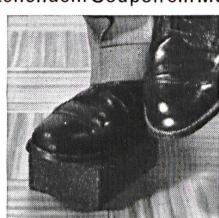
**Stark und starr** – Legen Sie Ihr FOAMGLAS-Muster auf den Boden und stehen Sie darauf: Es wird nicht zusammengedrückt, denn seine Druckfestigkeit ist  $7 \text{ kg/cm}^2$ . FOAMGLAS ist auch formbeständig und kann weder schwinden noch quellen.
