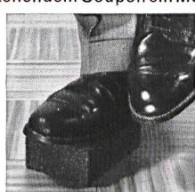
**Stark und starr** – Legen Sie Ihr FOAMGLAS-Muster auf den Boden und stehen Sie darauf: Es wird nicht zusammengedrückt, denn seine Druckfestigkeit ist 7 kg/cm². FOAMGLAS ist auch formbeständig und kann weder schwinden noch quellen.
