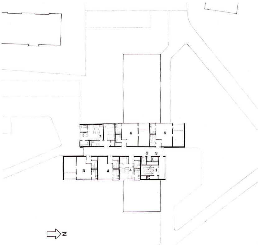
Das Hochhaus ist in Stahlbeton konstruiert. Die Flur- und die Wohnungstrennwände haben tragende Funktion. Die gesamte Außenhaut des Wohnhochhauses ist in farblich differenzierte Betonsteinplatten unterteilt, die als Fertigbauteile – innenseitig mit Wärmeisolierung und Dampfsperre versehen – auf die Baustelle kommen und mit dem Kran montiert werden. Diese Betonsteinplatten dienen nach außen hin gleichzeitig als Schalung, die fest mit dem Bauwerk verbunden ist (verlorene Schalung).
