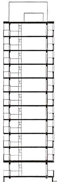
Lehmschicht geführt wurden. Die Deckenplatten sind 16 Zentimeter stark und überspannen 6,50 Meter. Ein 90 Zentimeter hoher Ringbalken hält die Häuser im ersten Geschoß zusammen.
