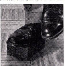
Stark und starr — Legen Sie Ihr FOAMGLAS-Muster auf den Boden und stehen Sie darauf: Es wird nicht zusammengedrückt, denn seine Druckfestigkeit ist 7 kg/cm<sup>2</sup>. FOAMGLAS ist auch formbeständig und kann weder schwinden noch quellen.
