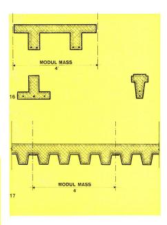
Angestrebte Betonbalken-Normen für Vorfabrikation. Poutres de béton normalisées pour la préfabrication. Concrete beam norms for prefabrication
