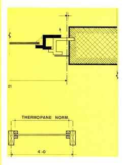
Normierte Stahlfensterrahmen. Der Wunsch nach Unabhängigkeit von der anschließenden Konstruktion führt zu einer Verbreiterung des Rahmens. Cadre de fenetre normalisé. Le désir d'être indépendent de la construction des la constructions des la construction des l
