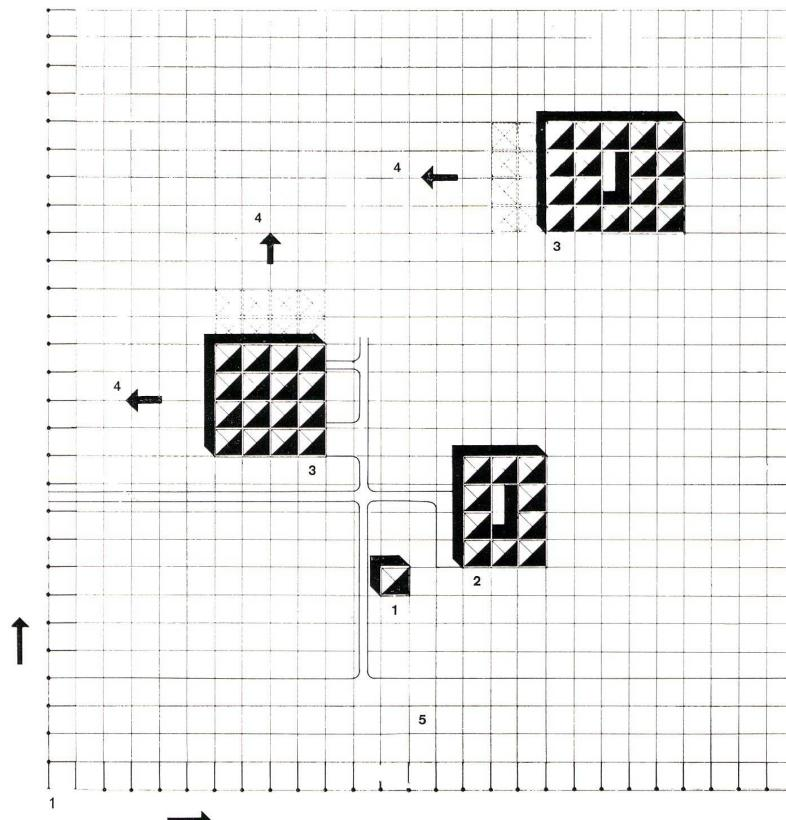
Die Tragkonstruktionseinheiten mit den Abmessungen von  $24 \times 24$  m sind für den Bau von eingeschossigen Bauten geeignet. Auf  $576\text{ m}^2$  Dachfläche wird eine Stütze – die Mittelstütze der Einheit – benötigt. Die vier I-Träger von 25 cm als »Kehlbalken« und die sekundären Fachwerkträger im Bereich der vier dreieckförmigen und zur Stütze geneigten Dachflächen weisen ein relativ geringes Eigengewicht auf.
