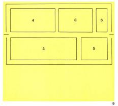
Mit Hilfe des Blockschemas und eines entsprechenden Entwurfes des Architekten entsteht das sogenannte Block-Layout: hier wird der architektonische Grundrißversuch sichtbar; Fassaden, Fenster, Gänge, Aufzüge usw. sind zu berücksichtigen (Abb. 9). Das Blockschema und das Block-Layout bilden die Grundlage für die sogenannte Feinplanung.
