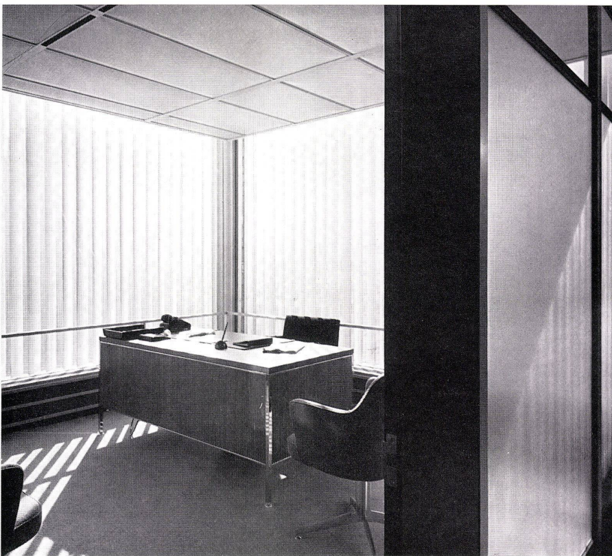
Die Fenster gehen fast bis zum Boden und bis zur Decke. Austritte der Klimaanlage unter den Fenstern. Inneres Geländer, senkrechte Sonnenblenden. Les fenêtres ont presque la hauteur de la pièce. Bouches de climatisation sous les fenêtres. Garde-fou intérieur, brises-soleil verticaux. The windows are carried almost to floor and to ceiling levels. Air-conditioning vents below the windows. Inner railings, vertical sun-blinds.
