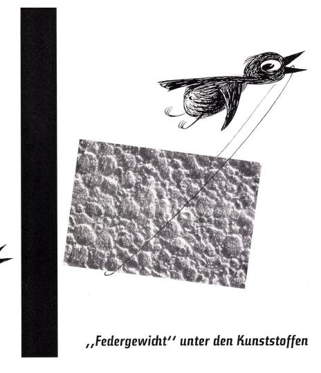
Ein Kubikmeter aufgeschäumtes ® STYROPOR – des mikroporösen Kunststoffes der BASF – wiegt etwa 20 kg. Dabei ist dieses "Federgewicht" nicht etwa schwach auf den Beinen; es zeichnet sich durch gute Stabilität aus. So können zum Beispiel Bauplatten aus STYROPOR während des Verlegens begangen werden.
