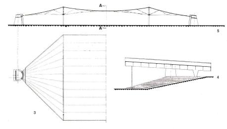
Die Dachkonstruktion besteht aus zwei Verankerungstürmen aus Spannbeton, die in einem gegenseitigen Abstand von 80 m aufgestellt sind. Zwischen diesen Türmen stehen rechtwinklig zur Verbindungslinie 3,60 m hohe Spannbetonbalken in einem gegenseitigen Abstand von 40 m.
