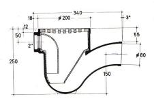
Eintauchzylinder (Geruchverschluß) mit Gummiringdichtung (alterungsbeständig)
