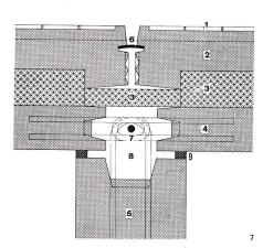
Horizontalschnitt durch die Fuge zwischen zwei Fassadenelementen der Fabrikhalle.
