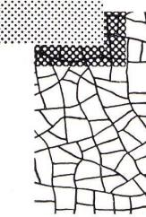
Bei bereits gestrichenen Innenwänden (Kalkschlämme oder Leimfarben), die sich nur schwer porensauber reinigen lassen, verhilft zu einem neuen verlässlichen Farbträger
