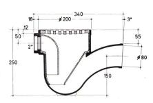
Eintauchzylinder (Geruchverschluß) mit Gummiringdichtung (alterungsbeständig)
