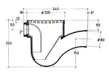
**Eintauchzylinder** (Geruchverschluß) mit Gummiringdichtung (absolut alterungsbeständig)
