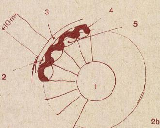
1 Anordnungsschema bei dichtester Flächenausnutzung. 100 Elemente (Trichterhäuser) mit Durchmesser von 200 m, Höhe 100 m, Öffnungswinkel 90° ergeben auf einer Flächeneinheit von 4,2 km<sup>2</sup> eine Einwohnerzahl von 200000 Menschen. Natürlich stellt eine solche dichte Bebauung einen Extremfall dar, obwohl zu bedenken ist, daß selbst in diesem Falle am Erdboden weitaus genügend Raum für den Großverkehr vorhanden wäre. 42 km<sup>2</sup>, d. h. 7 x 6 km, ergäben Raum für 2 Mill. Einwohner.
