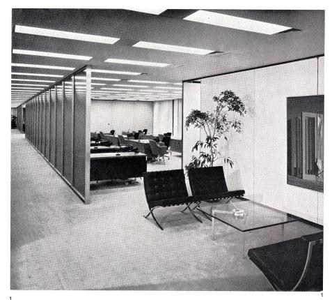
Blick aus einer Besprechungsecke in eines der offenen Büros. Man beachte die Lösung der Decke, wo neben leuchtenden Deckenteilen Austrittsöffnungen für die Klimaanlage liegen.
