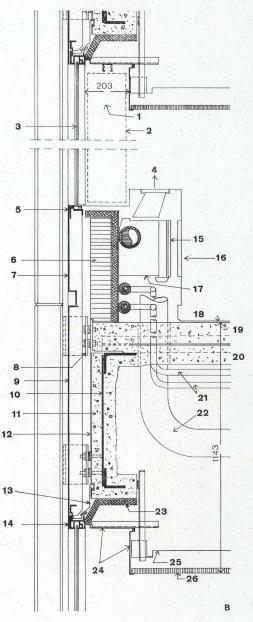
Grundriß einer Curtain-Wall-Sprosse 1 : 5. Profil d'un pilier de façade.
