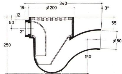
**Gehäuse** mit Auslauf von 80 mm
