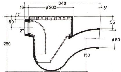
**Gehäuse** mit Auslauf von 80 mm
