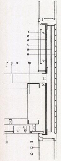
Vertikalschnitt durch die Brüstung, Deckenstirne und Sturz 1:15.
