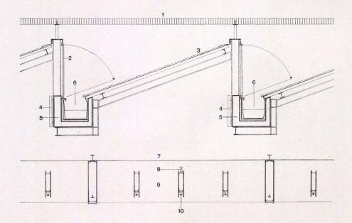
Querschnitt durch Oberlicht mit Beschattungsrost und Akustikrost 1:30.
