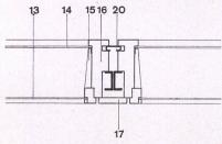
Horizontalschnitt durch Fenster und tragende Stütze 1:15.
