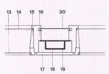
Horizontalschnitt durch Brüstung und tragende Stütze 1:15.
