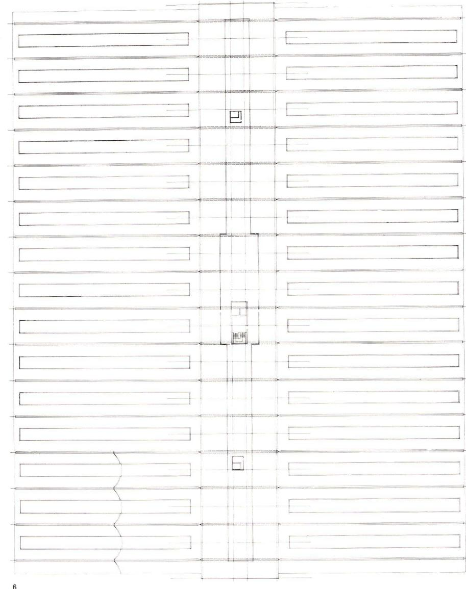
leicht überhöht. In Längsrichtung der Halle ist die Schale in Schmetterlingsform ausgebildet. Zwischen je zwei Schalen befindet sich ein Oberlicht.
