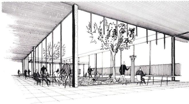
und ein L-förmiger Baukörper, in dem sich die Räume für das Publikum befinden, umgeben einen zentralen Platz, auf dem das Büchermagazin steht. Die Anordnung erleichtert offensichtlich die Verbindung zwischen den drei Teilen.
