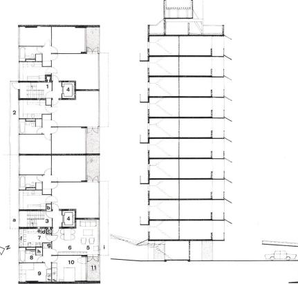
Westansicht. Die Wagen werden in das Säulengeschoß oder in die überdeckte Halle auf der Nordseite gestellt. Die Einstellhalle auf der Nordseite ist mit einem Faltdach aus 7,5 cm dickem Stahlbeton überdeckt.
