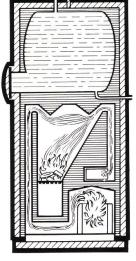
die moderne Heizkessel-Boiler-Kombination
