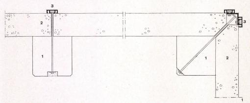
Horizontalschnitt durch Stahlbetonpfeiler und Wandplatte 1:12,5.
