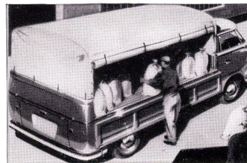
Plane und Spriegel sind im Handumdrehen auf- oder abmontiert. Einzeln klappbare Bordwände machen die Ladefläche von allen drei Seiten bequem und schnell zugänglich.
