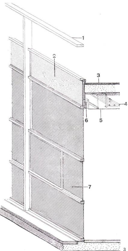
Im Hochhaus, genauer vom 3. Obergeschoß an aufwärts, sind Betonbrüstungen vor die Calorexplatten montiert worden. Zwischen diesen und der Betonbrüstung ist ein entlüfteter Zwischenraum (Abb. 2). In diesen Zwischenraum sind Leuchtstoffröhren montiert, die nachts zu Reklamezwecken eingeschaltet werden.
