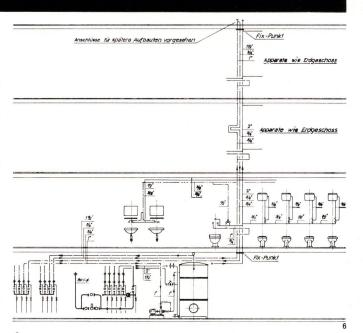
Schema der Kupferrohrleitungen für Kaltund Warmwasser im neuen Verwaltungsgebäude der Metallwerke Dornach.
