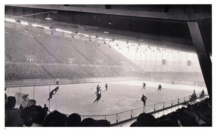
1 Die Halle faßt 10 000 Zuschauer. Die Heiz- und Kühlaggregate sind überall hinter die Fenster gehängt. Dadurch wurden Kanäle überflüssig; die Frischluft wird durch ein Luftgitter im Fenster angesogen.
