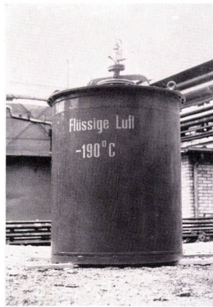
Transportbehälter für flüssige Luft – Isolationsstärke 22 cm
