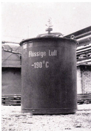
Transportbehälter für flüssige Luft – Isolationsstärke 22 cm
