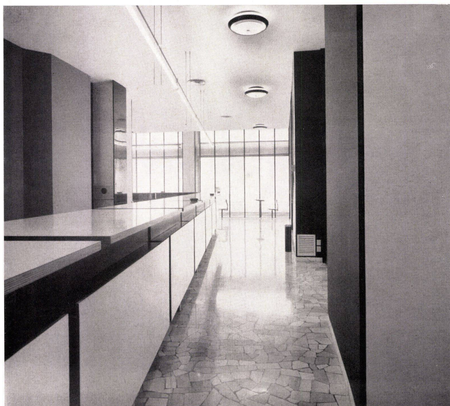
Blick vom Eingangsvorplatz in den Schalterraum. Die Luftkanäle sind hinter den Fassadenpfeilern eingerichtet (Ab-luftgitter).
