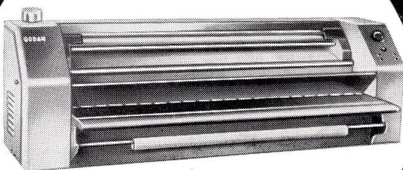
Papierdurchlaß 110 cm, Leistung pro Min. 40–130 cm, Max. Geschwindigkeit pro Min. 0–180 cm, Lichtquelle 4 x 65 Watt mit Reflektor, Anschluß 220 Volt, 2 Ampère, Stromverbrauch 300 Watt, Länge 170 cm, Tiefe 50 cm, Höhe 54 cm, Gewicht 137 kg.
