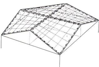
5 System von vier gleichseitigen Hyparschalen bei voller Belastung, die gleichförmig je horizontale Flächeneinheit verteilt ist. Die Pfeile geben die Schubkräfte an, wie sie auf die steifen Randglieder übertragen werden.
