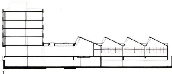
1 Querschnitt durch Magazin und Werkstattgebäude 1:800.
