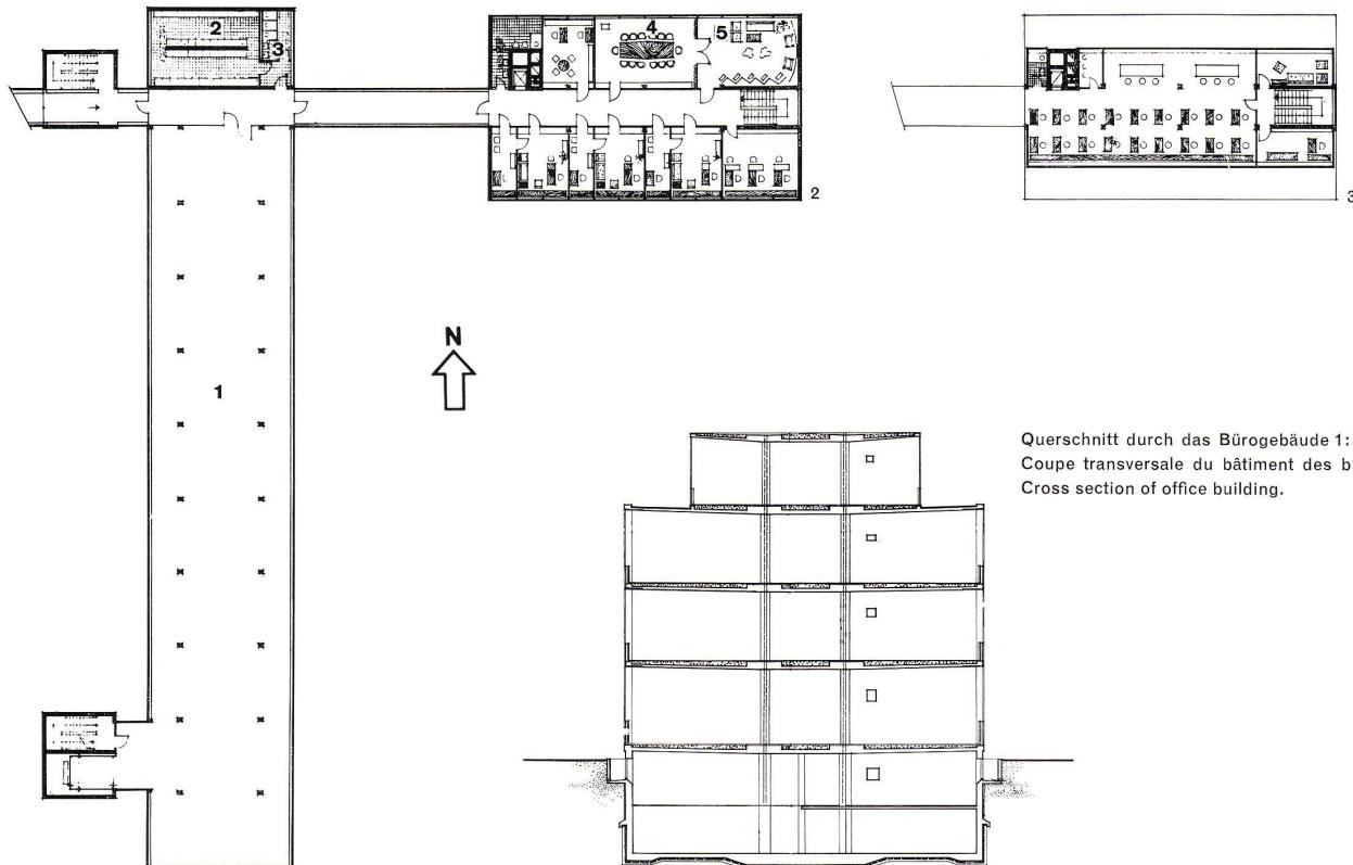
Querschnitt durch das Bürogebäude 1:300.
