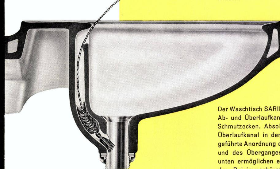
Der Waschtisch SARINE-PROGRESS hat glatte Ab- und Überlaufkanäle ohne die geringsten Schmutzecken. Absolut fugenlos mündet der Überlaufkanal in den Ablauf ein. Die flüssig geführte Anordnung der Überlauföffnung oben und des Überganges in die Gewindebüchse unten ermöglichen es, dass jede Stelle mit der Reinigungsbürste gründlich bestrichen werden kann. So lassen sich Ab- und Überläufe stets makellos sauber halten.
