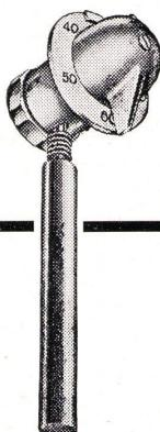
Das Danfoss Radiatorventil verfügt (anstelle des üblichen Handrades am Radiator) über einen Einstellgriff, an welchem die gewünschte Raumtemperatur eingestellt wird. Ein mit diesem Ventil verbundener Fühler überwacht dauernd die Raumtemperatur und reguliert mit einer Genauigkeit von  $\pm \frac{1}{2}^\circ\text{C}$ .
