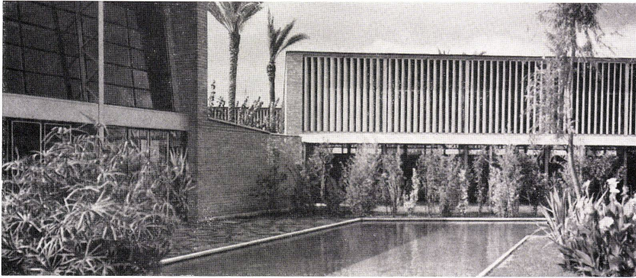
1 Der zweite Angestelltenspeisesaal mit den typischen senkrechten Brises-soleil aus Aluminium und dem großen Wasserbecken. La deuxième salle à manger des employés avec les brises-soleil verticaux en aluminium et le grand bassin. The second employees' dining-room with the typical vertical sunbreak of aluminium and the large pool.
