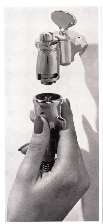
Doppelt gesicherter Gashahn mit Bajonettverschluß Nr. 8597 pat. Dieser Gashahn wird für Waschmaschinen, Réchauds usw. verwendet. Die doppelte Sicherung besteht in folgender Funktionsweise: nur bei geschlossenem Hahnen kann das Anschlußstück entfernt werden, beziehungsweise erst, wenn dieses wieder am Hahnen angebracht ist, kann derselbe geöffnet werden. Andererseits kann bei geöffnetem Hahnen das Anschlußstück nicht abge-
