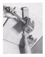
Brigatex wird auf die miteinander zu verleimenden Flächen mit hartem Pinsel oder mit einer Spachtel aufgetragen und offen liegengelassen. Bei einer Raumtemperatur von ungefähr 16 Grad Celsius wird nach etwa 15 Minuten durch bloßes Anklopfen verleimt.
