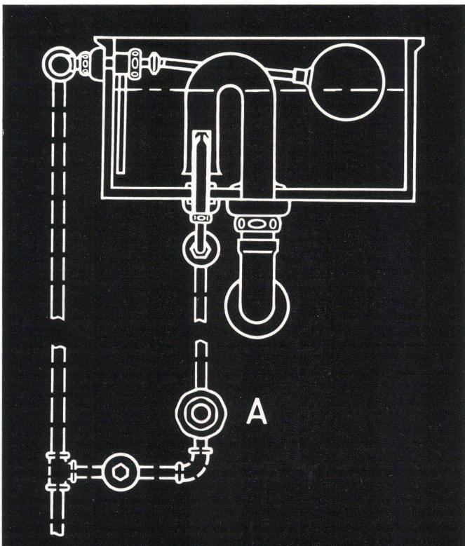
Glatte hygienische Außenkonturen und solide Konstruktion mit O-Ring-Abdichtung kennzeichnen das KWC-Drückerventil No. 5864 für Injektor-Spülkasten.
