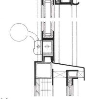
Abb. 6 Vertikalschnitt durch untere Partie eines Vertikal-Schiebefensters (Guillotine), System «Zwahlen & Mayr». Einfachverglasung, Anschlußbeispiel an Fensterbrüstung. Fabrikation: Zwahlen & Mayr S.A., Lausanne/Malley.
