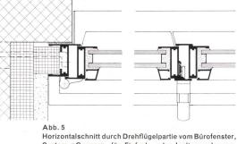
Horizontalschnitt durch Drehflügelpartie vom Bürofenster, System «Gauger», für Einfach- oder Isolierverglasung, doppelter Metallanschlag. Fabrikation: Gauger & Co. AG., Zürich.
