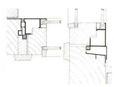
Abb. 18 Links: Horizontalschnitt, rechts: Vertikalschnitt durch Schwingflügelfenster «Aluh», System «Schmidlin». Kombination Holz/Leichtmetall. Äußerer Flügel in Leichtmetall.
