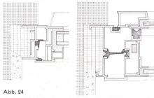
Horizontalschnitt durch isoliertes Drehflügelfenster, System «Koller». Zwei Luftkammern. Trennung der innern und äußern Rahmen mit Isolierstoff. Fabrikation: Metallbau Koller AG., Basel.
