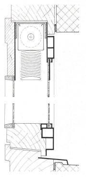
Abb. 19 Vertikalschnitt durch «Tlach-Kiener»-Schwingflügelfenster, Kombination Holz/Leichtmetall. Äußere Profile in Leichtmetall. Fabrikation: Tlach-Kiener, Fensterfabrik, Bern; Hans Kißling, Eisenbau AG., Bern.
