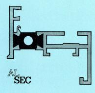
Die in allen Einzelheiten durchdachte Konstruktion der isolierten ALSEC-Leichtmetall-Profile gewährleistet besten Schutz gegen Schwitzwasser-Bildung und Vereisung der Fensterrahmen.
